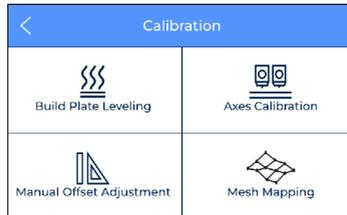
1. **Nivellement du plateau** : ce processus permet de s'assurer que le plateau est bien placé à plat avant l'impression. Essentielle pour obtenir de bons résultats, cette opération très simple Ce processus est également inclus à la rubrique [Assistant de configuration](#).
