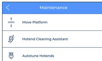
1. **Déplacer la plateforme** : Cette fonction sert à abaisser ou relever la plateforme de construction. C'est une opération très simple qui permet de séparer la plate-forme des têtes d'impression.
